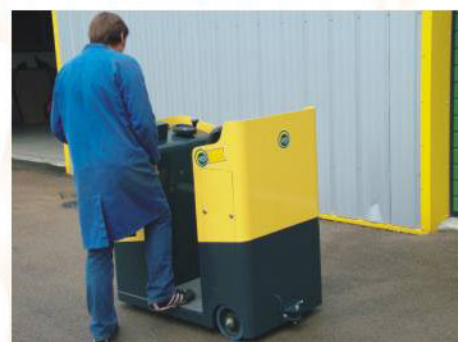
Plancher bas (115 mm)
